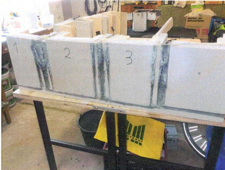
Bild 1 Zur Überprüfung des Versuchsaufbaus auf eventuelle Schäden infolge der Feuerbeaufschlagung wurde der gesamte Versuchsaufbau nach dem Abkühlen in der Hälfte durchtrennt.
