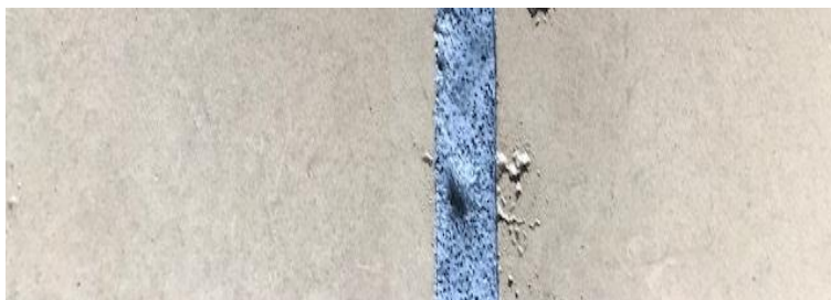
Abstand 100 cm, Punktstrahl – Dreckfräse- 10 Sekunden, Druck 100 bar
