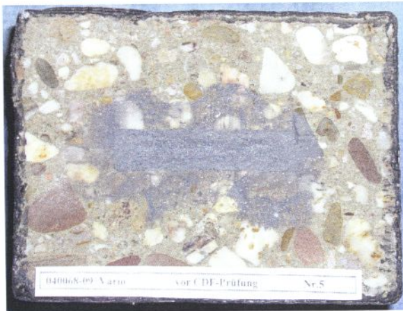
Bild 9: Probekörper 2.2 vor CDF-Prüfung
