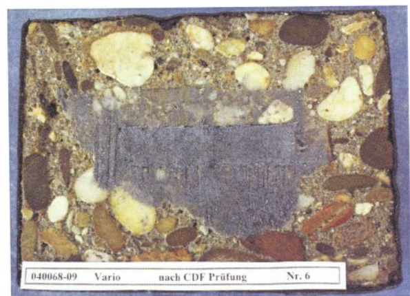
Bild 12: Probekörper 2.3 nach CDF-Prüfung
