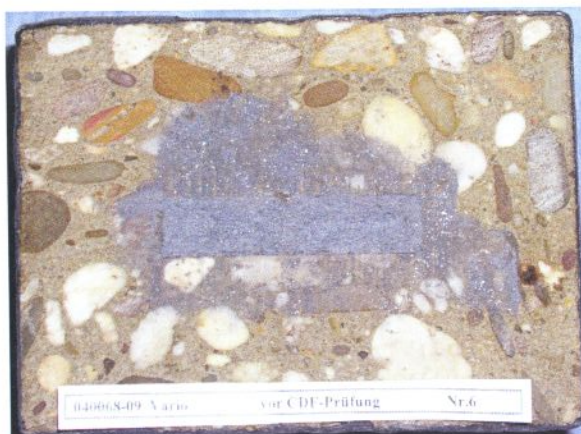
Bild 11: Probekörper 2.3 vor CDF-Prüfung
