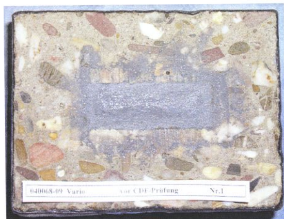
Bild 1: Probekörper 1.1 vor CDF-Prüfung
