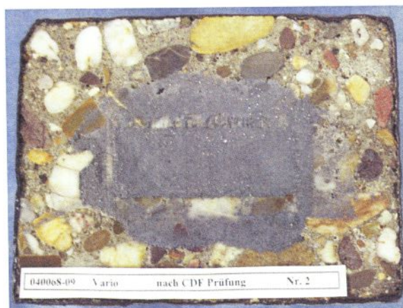
Bild 4: Probekörper 1.2 nach CDF-Prüfung
