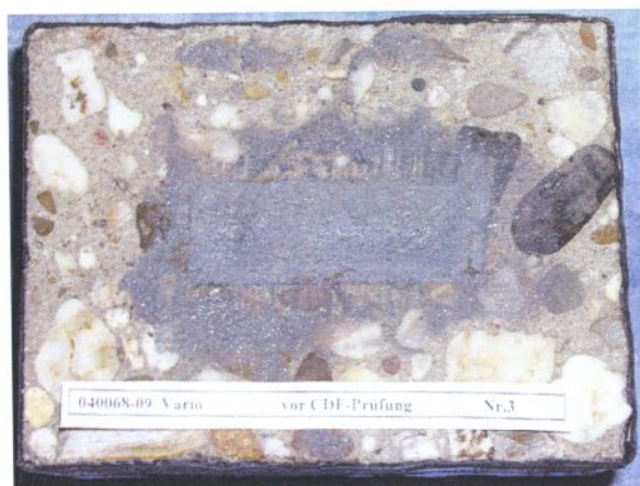
Bild 5: Probekörper 1.3 vor CDF-Prüfung
