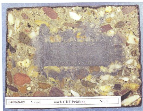
Bild 2: Probekörper 1.1 nach CDF-Prüfung
