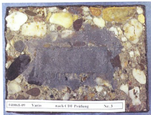
Bild 6: Probekörper 1.3 nach CDF-Prüfung
