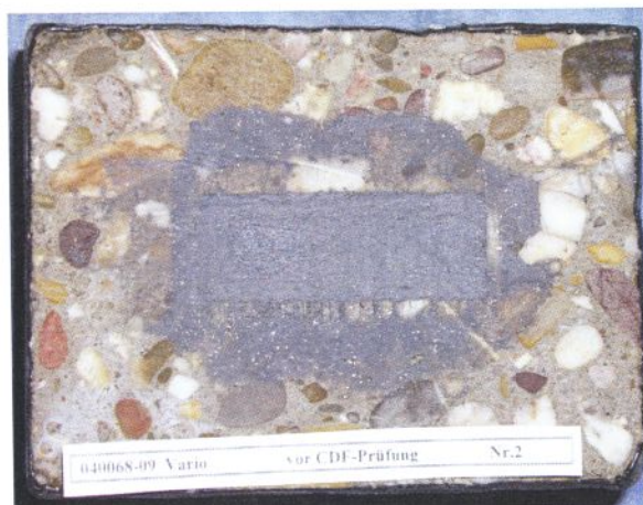
Bild 3: Probekörper 1.2 vor CDF-Prüfung
