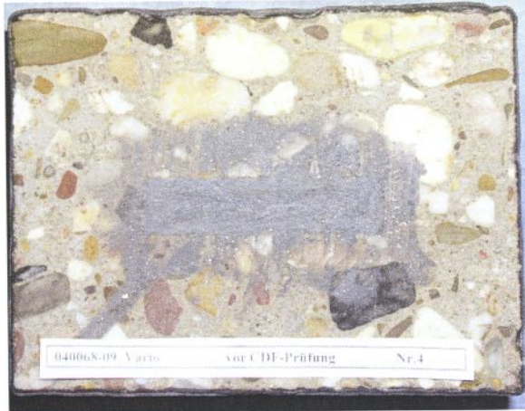
Bild 7: Probekörper 2.1 vor CDF-Prüfung
