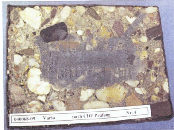
Bild 8: Probekörper 2.1 nach CDF-Prüfung
