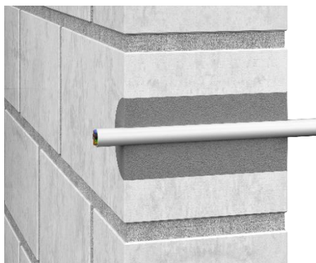
Einzelkabeldurchführung nach MLAR
