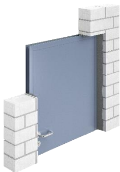
Einmörtelung von Brandschutztüren
